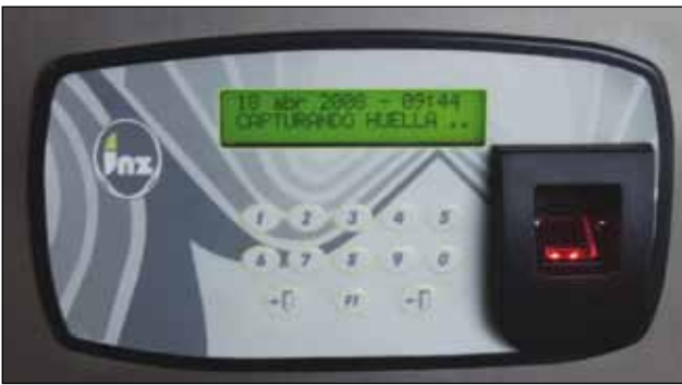
Fig. 4. Grazie all'interfacciamento del controllo accessi (impronte digitali) con il sistema KNX, sono possibili il controllo e la regolazione di tutti gli impianti in funzione delle effettive esigenze
