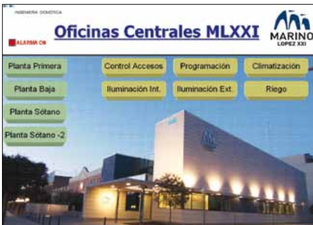
Fig. 5. Pagina di avvio della visualizzazione: controlli semplici e modifica di tutti gli impianti.
